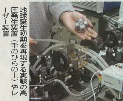
地球誕生初期を再現する実験の高温発生装置(手のひらの上)やレーザー装置
